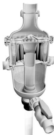
L'eau entre tangentiellement dans les 12/16 hydrocyclones, créant un effet centrifuge puissant. Les sédiments sont projetés vers les parois de l'hydrocyclone pour ensuite descendre en spirale vers le réservoir à sédiments. L'eau filtrée migre vers le centre de l'hydrocyclone où l'écoulement s'inverse et s'écoule en spirale par la sortie.
